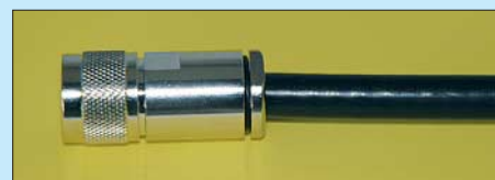
Bild 31: Nach dem handfesten Anziehen der Mutter sollte ein schmaler Spalt verbleiben.
