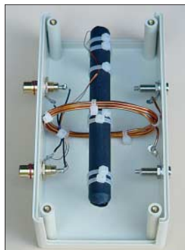
Bild 2: Die deutlich zu erkennende lose Koppelwicklung ermöglicht die Einkopplung des Signals einer Schleifenantenne in die direkt auf dem Ferritstab aufgebraute Wicklung.
