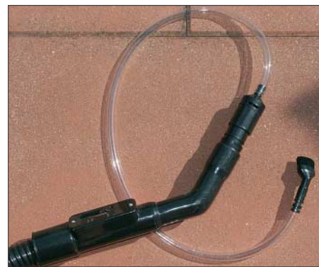
Erweiterung des normalen Haushaltstaubsaugers zu einem vollwertigen PC-Staubsauger – besser als jedes Exemplar für den USB-Port
