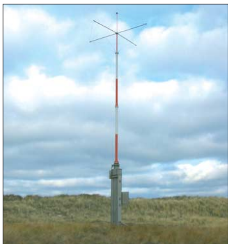
Bild 1: DGPS-Stationen senden GPS-Korrekturdaten auf Frequenzen um 300 kHz. Das Bild zeigt die Sendeantenne der Station Helgoland für 298,5 kHz.
