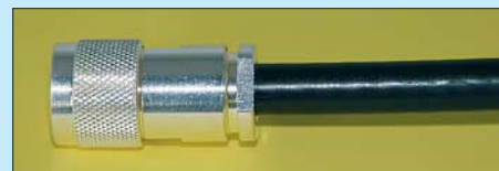
Bild 23: Die Mutter sollte man nicht bis zum Anschlag festdrehen – handfest reicht.
