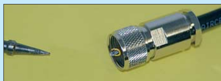
Bild 16: Nach dem Kürzen sind Innenleiter und Hülse zu verlöten.
