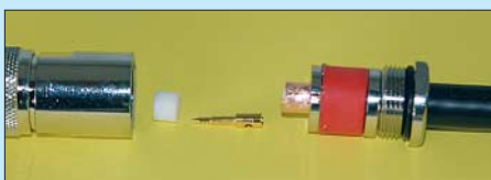
Bild 27: Nach dem Entwirren des Geflechts ist der Schafthkegel einzuschieben.
