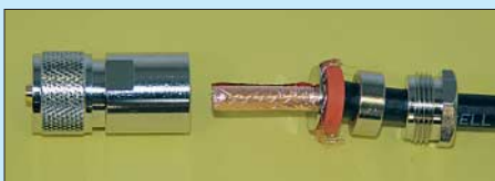
Bild 13: Der Schaftkegel ist vollständig zwischen Geflecht und Folie zu schieben.
