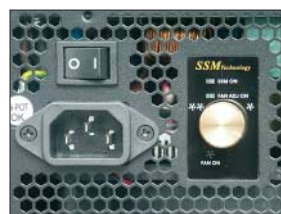
Temperatur und somit Drehzahl lassen sich bei diesem SSM-Netzteil auf der Rückseite regeln.
