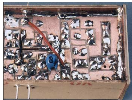
Bild 3: Detailansicht der Unterseite des Konverters mit gefrästen Leiterzügen
