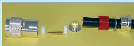
Bild 18: Mutter, Druckscheibe und Dichtung sind zuerst aufzufädeln.
