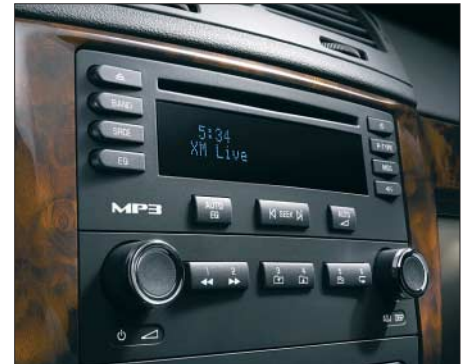
Bild 2: Satellitenradio-Empfänger fürs Auto unterscheiden sich äußerlich nicht von herkömmlichen Autoradios. Auf dem Autodach fängt eine kleine Flachantenne den Audiodatenstrom aus dem Orbit ein.
