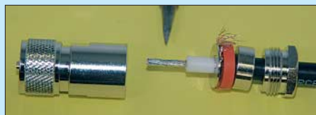
Bild 15: Ein Verlöten des Innenleiters verhindert das Aufdrehen der Drähte.
