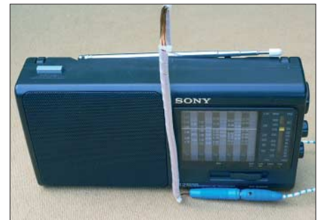
Bild 7: Legt man ein paar Windungen um einen Weltempfänger mit seiner Ferritantenne im Innern, lassen sich beliebige Schleifen- und Erdantennen ankopplern.
