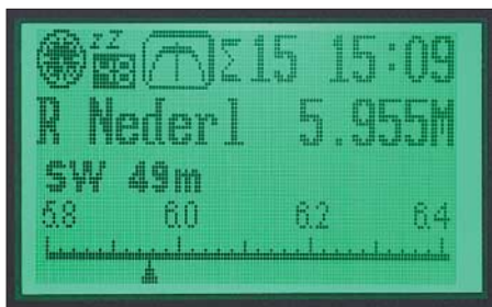
Bild 2: Das zweite LC-Display auf der Recordereinheit zeigt ständig Frequenz, Band, Uhrzeit und programmierte Stationsnamen.
