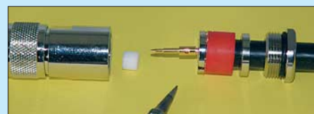
Bild 29: Das Festlöten des Innenstifts erfolgt über die kleine seitliche Bohrung.
