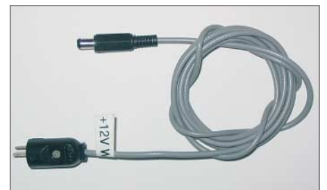
Bild 4: Beschriftung mittels Labelprinter für gerätespezifische Kabel
