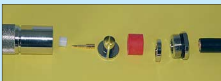
Bild 24: Zum N-Stecker N 1011 TG gehören acht Teile. Ein Innenstift wurde entfernt.
