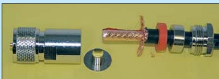
Bild 12: Nach dem Entfernen des Mantels muss man das Schirmgeflecht entwirren.
